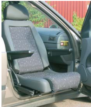
Die Plattform Turnout schwenkt den Sitz heraus, so dass Carony Go an das Auto andocken kann.
