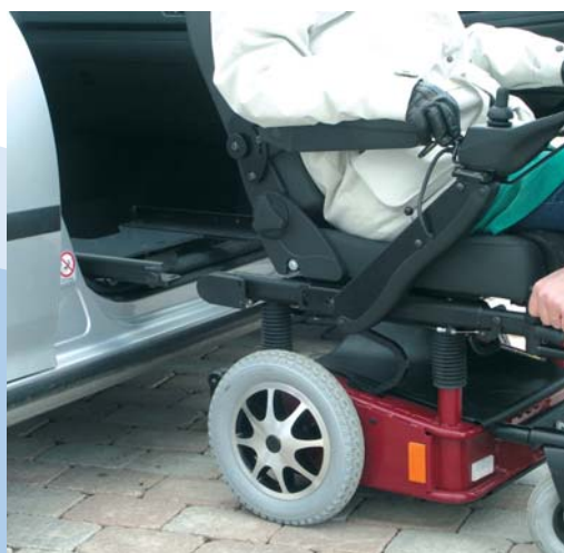
Motoren ausschalten, damit der Rollstuhl manuell rollen kann. Rollstuhl an die Schwenkplattformschienen andocken.
