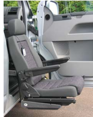
Bei Fahrzeugen mit höherem Boden wird Carony Go mit Turny HD oder Turny Orbit kombiniert.
