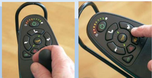
Verriegelung lösen und Steuerarm niederklappen. Die Steuereinheit kann auch weggeklappt werden.
