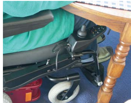
Der Steuerarm ist abklappbar, ein praktischer Vorteil z. B. beim Sitzen am Tisch.
