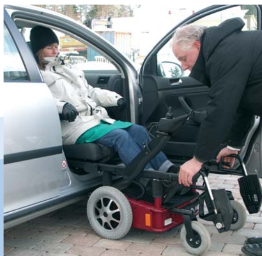
Fahrgestell von der Schwenkplattform lösen.
