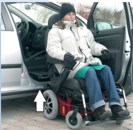
Rollstuhl mit der Steuereinheit auf die Höhe der Schwenkplattform anheben.
