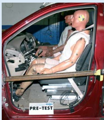
Crashtest des Turny Orbit in einem Toyota Sienna.
