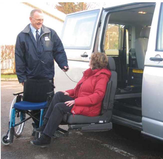
Turny Orbit ist leicht zu bedienen. Mit einem Tastendruck setzt der Fahrer den Passagier in das Fahrzeug. Hier ist das Produkt auf der rechten Seite der mittleren Sitzreihe eines VW Transporter T5 installiert.
