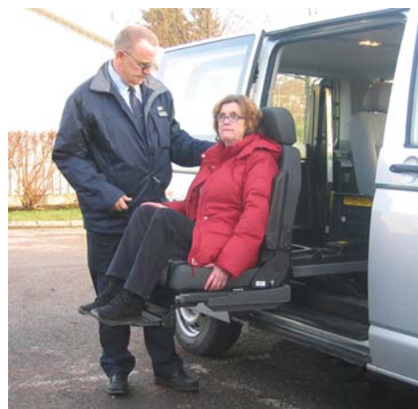
Turny Orbit ist leicht zu bedienen. Mit einem Tastendruck setzt der Fahrer den Passagier in das Fahrzeug. Hier ist das Produkt auf der rechten Seite der mittleren Sitzreihe eines VW Transporter T5 installiert.
