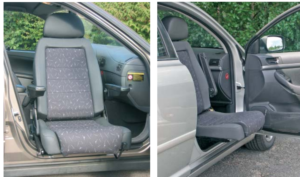
Turnout (hier mit Carony Rollschienen an den Seiten) wird in Kombination mit einem niedrigen Autositz (BEV-Sitz) eingebaut, so dass die Kopffreiheit nach oben erhalten bleibt. Hier ist der Sitz zusätzlich mit einer Armlehne ausgerüstet.
