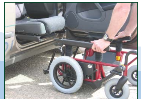
3. Lösen Sie den Carony-Fahrgestell und drehen Sie den Stuhl in die richtige Position im Auto. Legen Sie den Fahrgestell in den Kofferraum.
