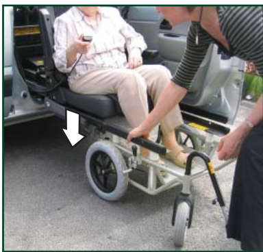
1. Turny auf die richtige Höhe absenken, um den Fahrgestell zu befestigen.
